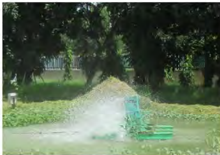
ภาพที่ 2-17 เครื่องเติมอากาศ
