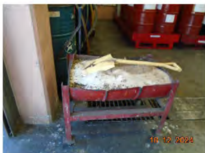
ภาพที่ 2-31 วัสดุสำหรับดูดซับน้ำเพลิง
